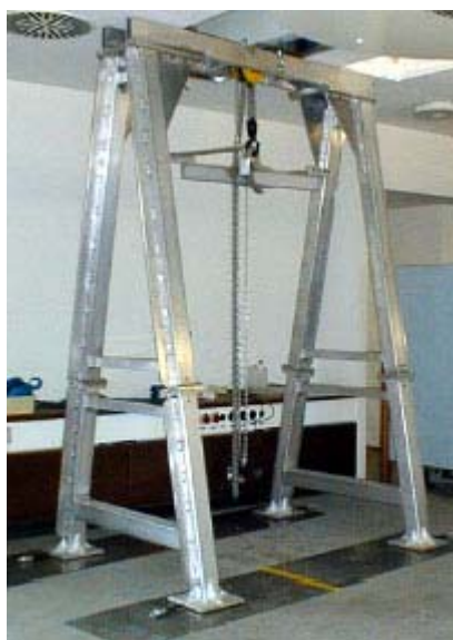
Figura 14.2. Bruker BioSpin - Plataforma de montaje especial - Estructura metálica en forma de A
