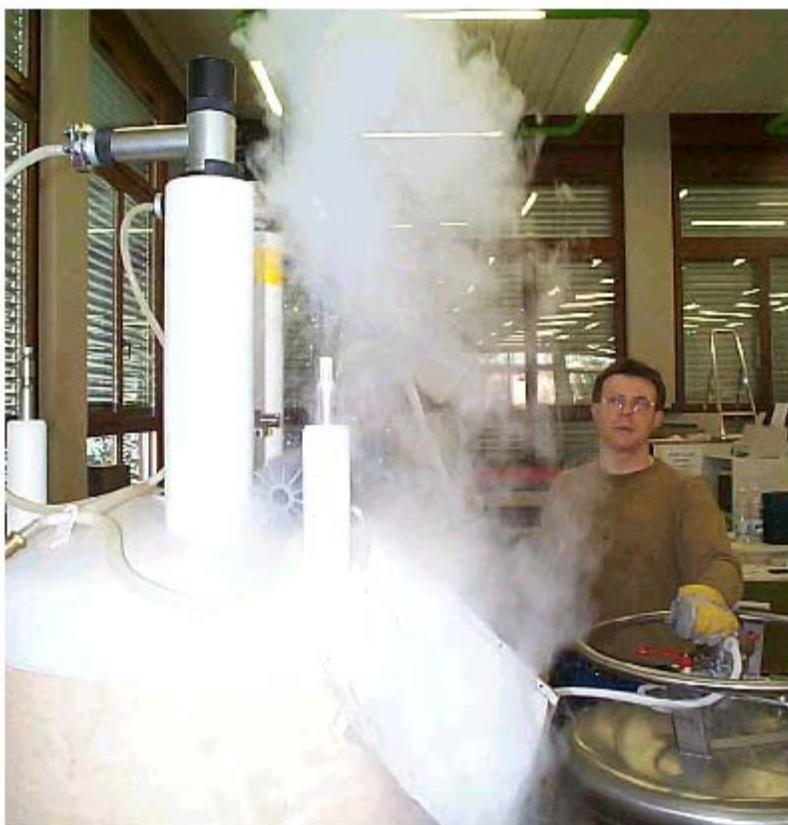
Figura 2.3. Figura 2.3 Disponga de ventilación adecuada durante el rellenado
