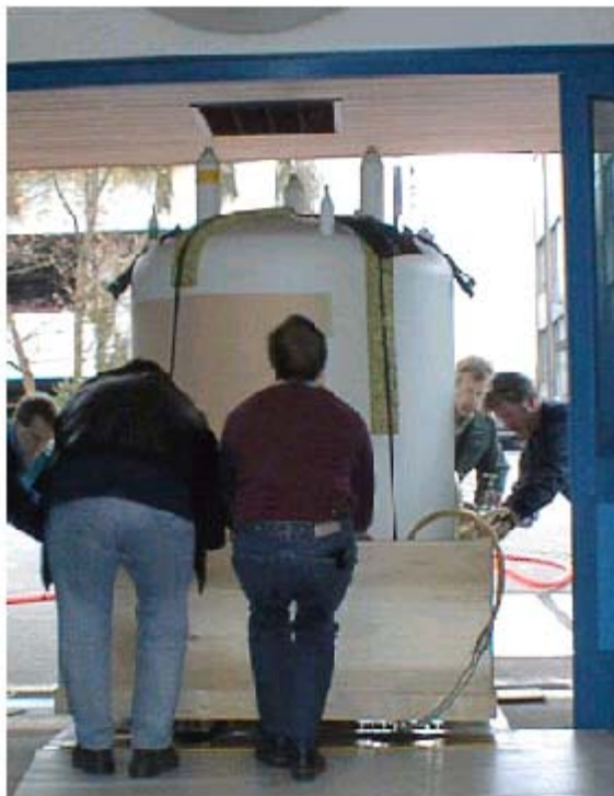
Figura 3.1. Moviendo el imán con un deslizador de aire a través de la puerta del laboratorio
