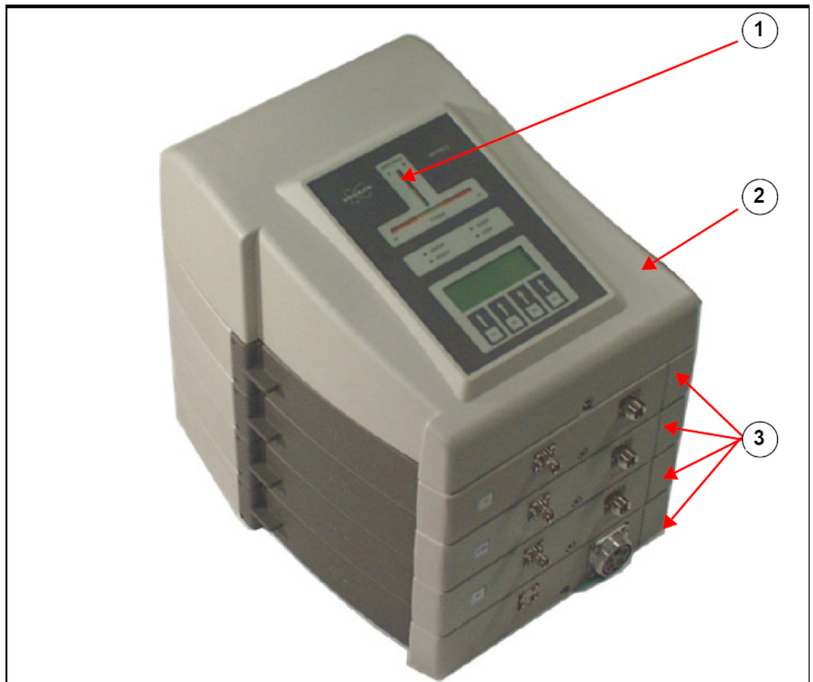
Abbildung 4.3: HPPR mit drei Modulen und Cover Modul
