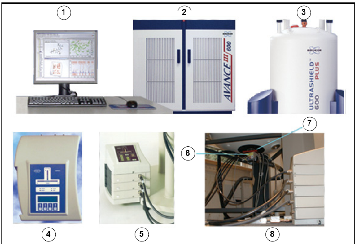
Figura 4.2: Imagen del imán, sistema de homogeneización, sonda y amplificador HPPR
