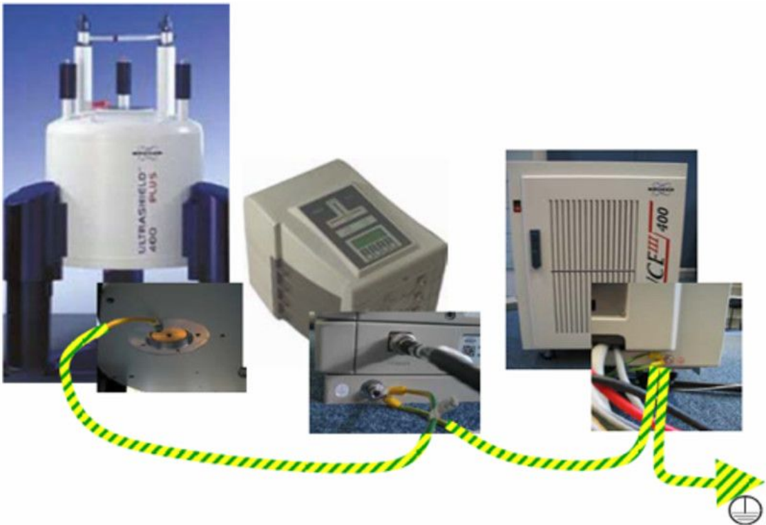
図 3.2: 外部プリアンプ付きAVANCE核磁気共鳴分光器 (HPPR/2)
