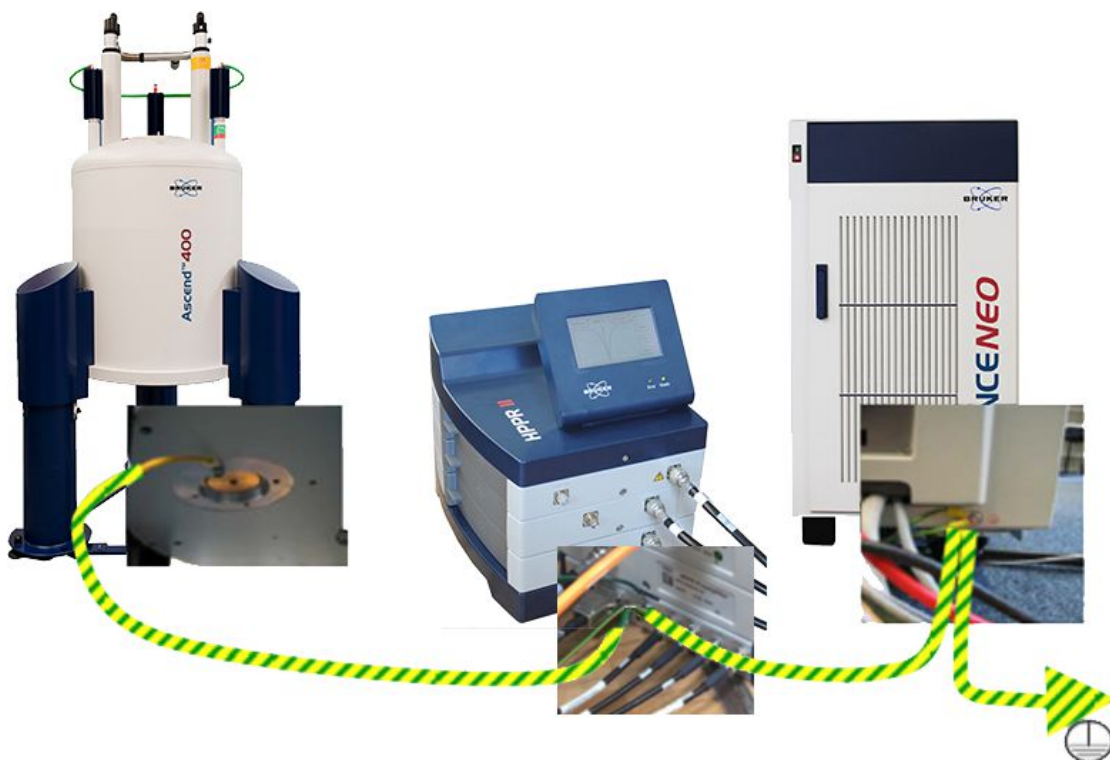
Figure 2.2: Spectromètre AVANCE avec préamp externe (HPPR/2)
