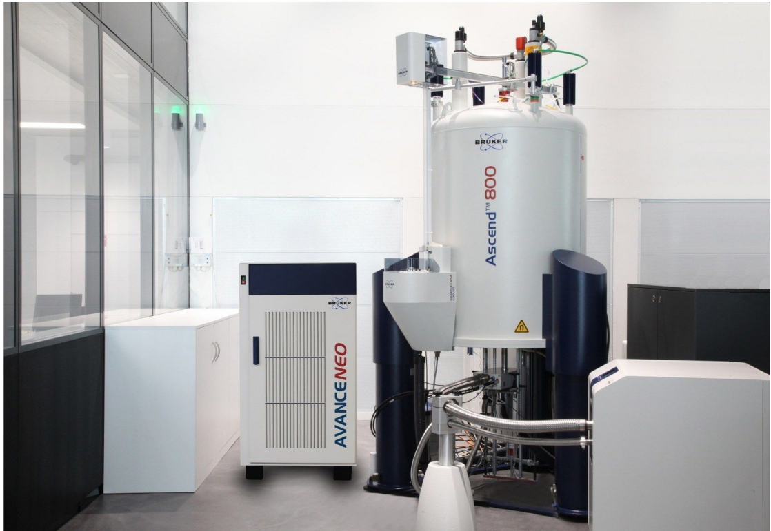
Rysunek 4.1: Konsola AVANCE NEO i magnes Ascend
